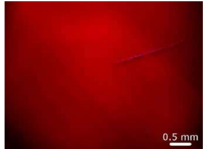
Figure 7 - Luminescence rouge au DiamondView™ soulignant des figures de croissance courbes, qui indiquent que ce synthétique a été obtenu par la méthode Verneuil.
