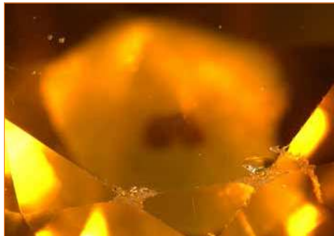
Figure 2 : Ebréchures importantes. Largeur du champ 3,5 mm Photo A. Delaunay© Laboratoire Français de Gemmologie.
